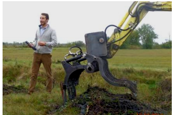
Griffe d'extraction mise au point par le groupe de travail du SAH Sud Loire en 2014 (Source SBVGL)
